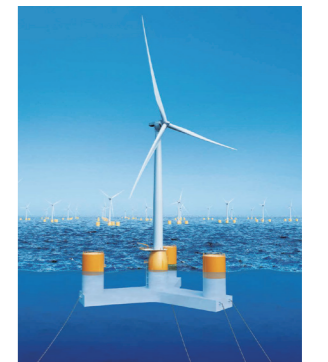
セミサブ型浮体基礎(浮体式) 銅製の箱形状のブロックで構成された海に浮かせる型式の基礎。波による揺れを抑えるため、浮体を所定の喫水まで沈めて半潜水状態としている。
