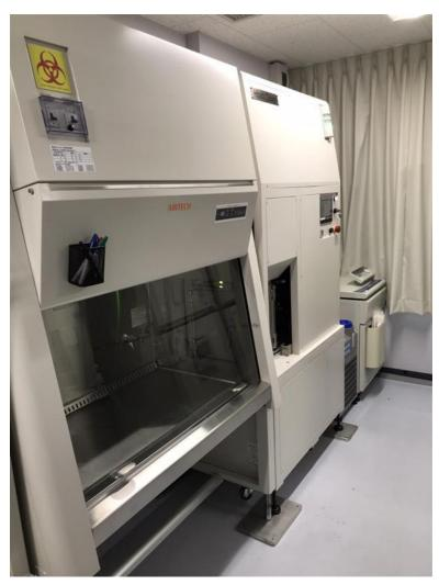
※手前から2番目の装置が今回導入したプロトタイプ。 左側の安全キャビネットへと滅菌した原料・原材料を導入する。
