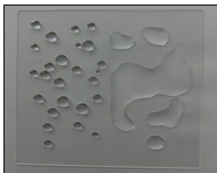
左：防汚膜成膜品 右：未処理品
