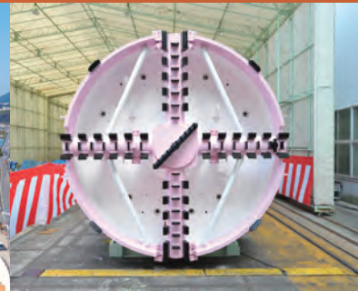
直径4.48m泥土圧シールド掘進機
