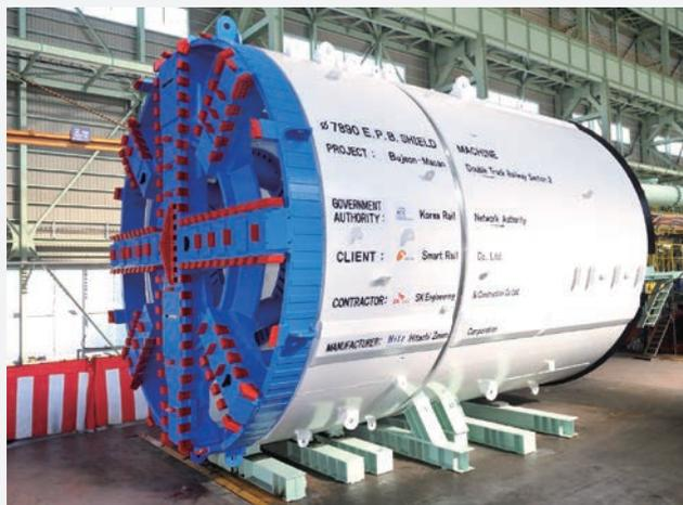
韓国Bujeon-Masan地下鉄向け泥土圧シールド掘進機
