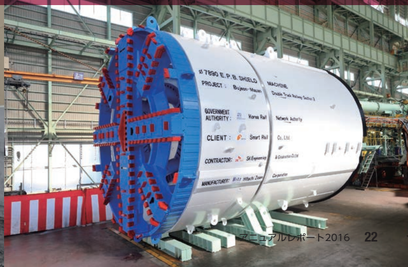
韓国向け泥土圧シールド掘進機
