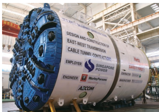
▲ シンガポール向けシールド掘進機
