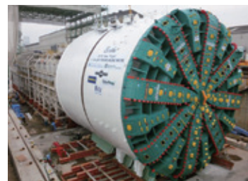
世界最大の泥土圧シールド掘進機
