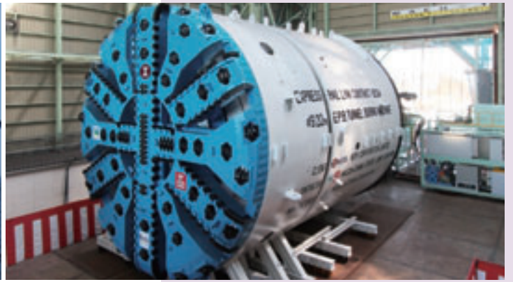
香港新幹線向けシールド掘進機
