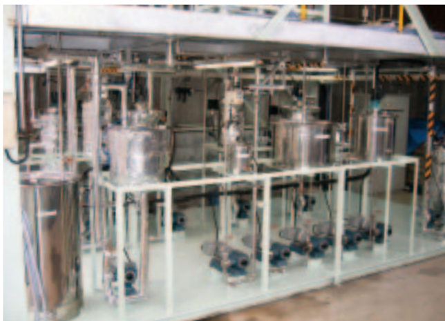
バイオディーゼル燃料連続製造システム
