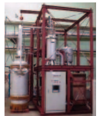
エタノール無水化装置
