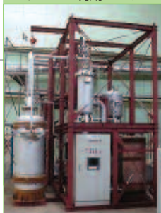
エタノール 無水化装置
