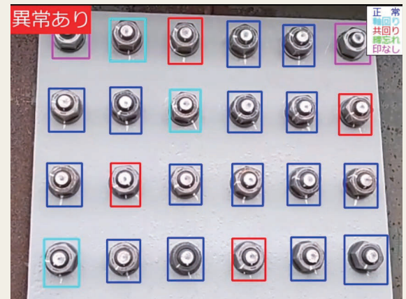
図8 複合現実デバイスを用いたシステムによる高力ボルトの締付状態判定結果例
