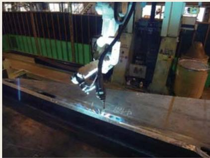
図1 ロボットMAG溶接
