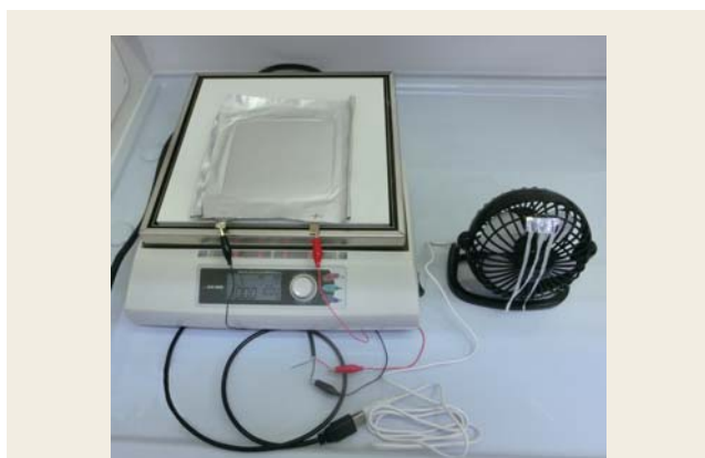
図9 100℃のヒーターブロック上での動作試験
