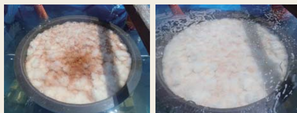
(a) ろ過直後 (b) 逆洗後 図13 SuRFF®実証機陸上試験時の写真
