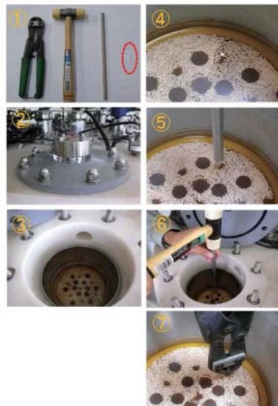
図10 膜損傷修繕
