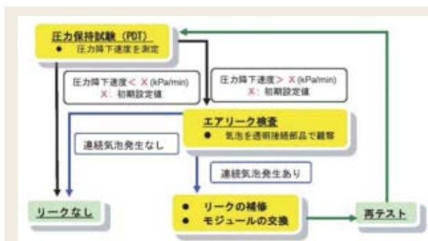
図8 圧力保持試験とエアリーク試験の手順
