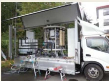
図11 C町 膜ろ過による応急浄水支援(AMF-180S)
