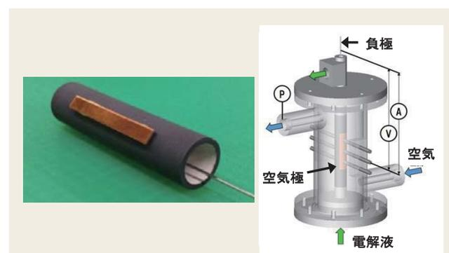
図1 試作電池画像(左)および電池評価治具模式図(右)
