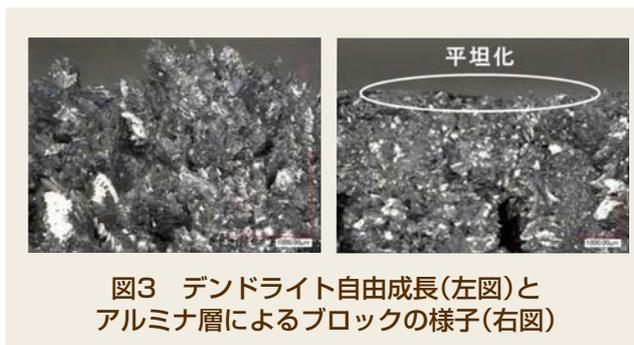
図3 デンドライト自由成長(左図)とアルミナ層によるブロックの様子(右図)
