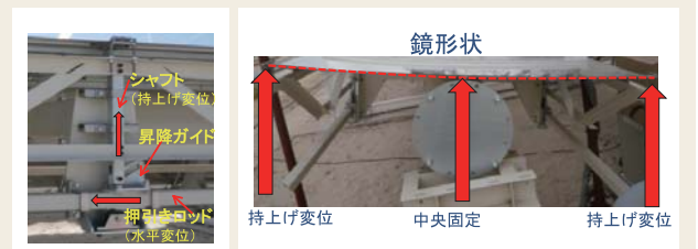
(b) 昇降機構 (c) 鏡面の曲げ=曲率半径制御
