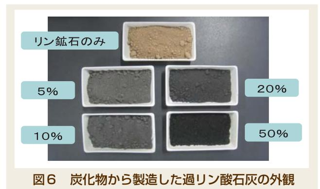
図6 炭化物から製造した過リン酸石灰の外観
