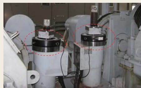
図12 ロードセルの取付状況
