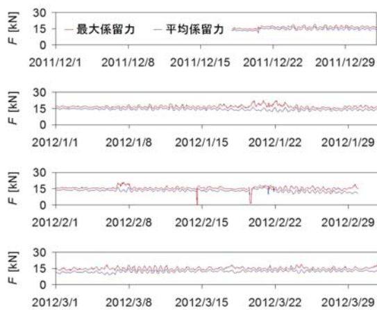
図13 フラップ式津波・高潮防波堤用扉体の係留力
