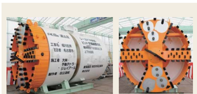
図40 ビット交換装置搭載φ4.19m泥土圧シールド
