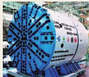
図19 \phi 10.82 岩盤泥水シールド
