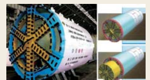
図24 \phi 5.89/4.39m 泥土圧親子シールド
