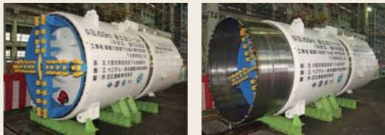
図27 掘削時 図28 既設管切削時
