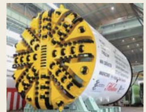
図22 バンガロール向け 6.44m岩盤泥水シールド
