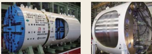
図29 分岐シールド 図30 分岐胴
