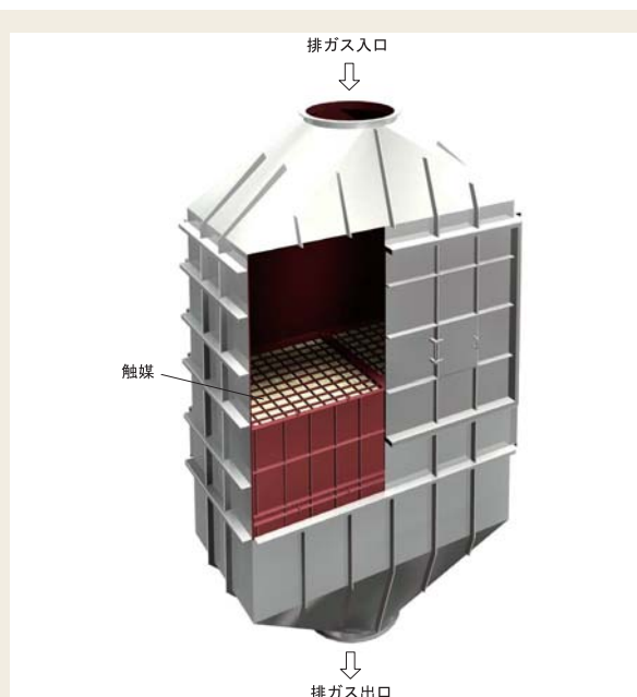
図8 触媒反応塔の概要
