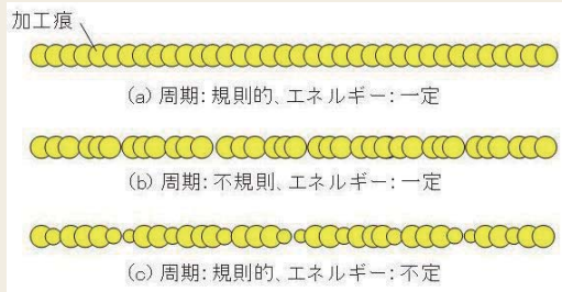
図6 加工に及ぼすレーザービームの安定性
