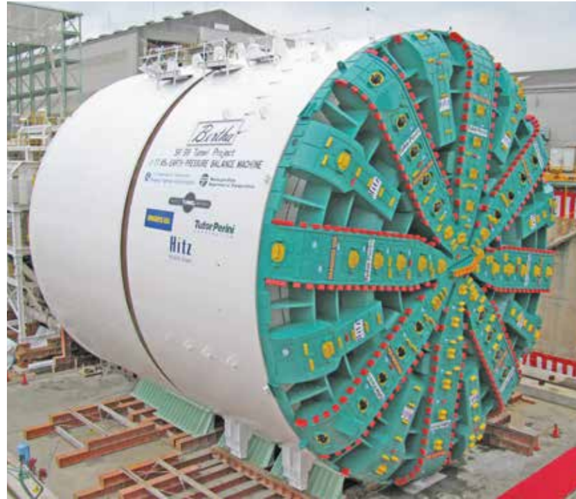
泥土圧シールド掘進機(世界最大級口径 17.45m) EPB shield tunnel boring machine (The world's largest, \phi 17.45m)
