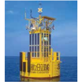
GPS 総合海洋観測システム GPS comprehensive oceanographic monitoring system
