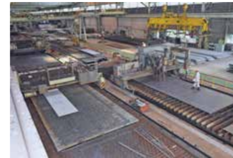
①NC切断機 NC cutting machines
