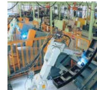
溶接ロボット Welding robots
