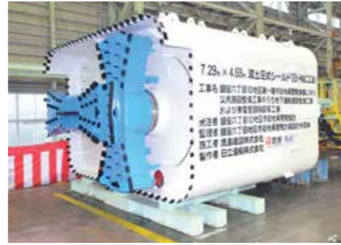
矩形シールド掘進機 Rectangular Shield tunnel boring machine
