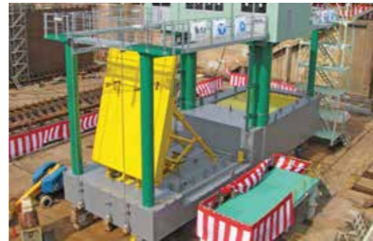
海底設置型フラップゲート式可動防波堤試験装置 Movable Flap-Gate type Breakwater system installed on the Seabed
