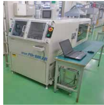
有鉛フローディップはんだ付け装置 Flow Dip Type Lead Solder
