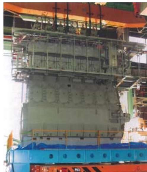
ディーゼルエンジン 一体搬出設備 Equipment for taking out diesel engine units
