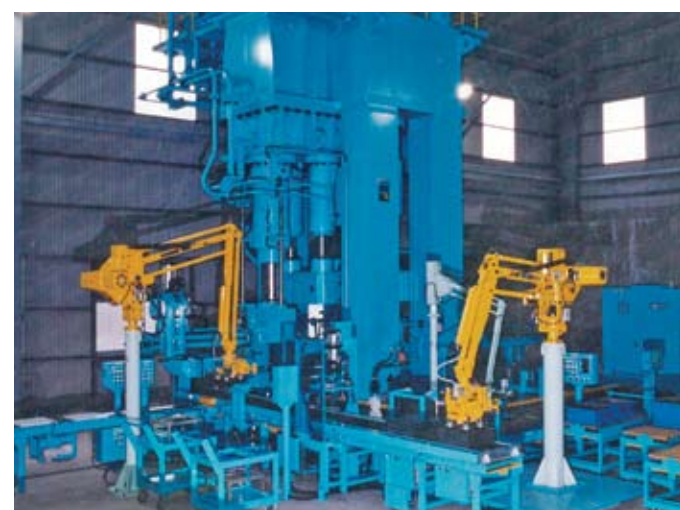
油圧プレス／3600トン Hydraulic press / 3600 ton
