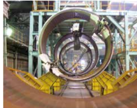
自動溶接機（直線溶接ライン） Automatic welding machine (Liner welding line)
