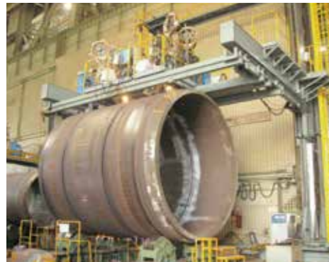
自動溶接機（周溶接） Automatic welding machine (Circumference welding)
