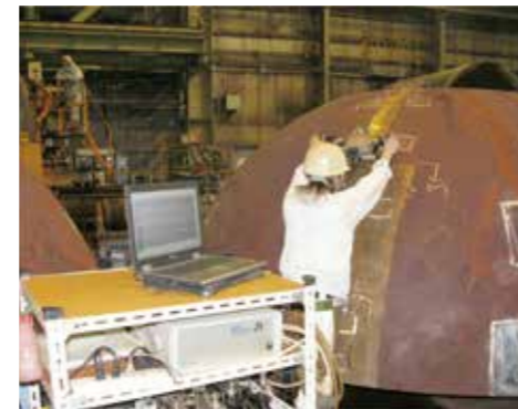
探傷検査設備（TOFD-IV） Flaw detection equipment (TOFD-IV)
