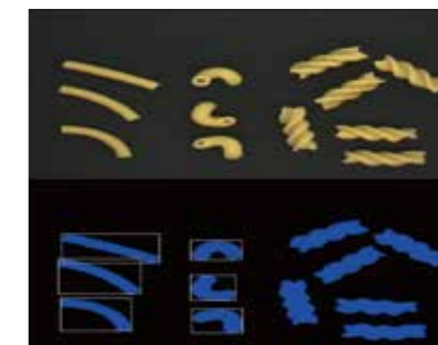
パスタの形状検査例 Example of shape inspection of pasta
