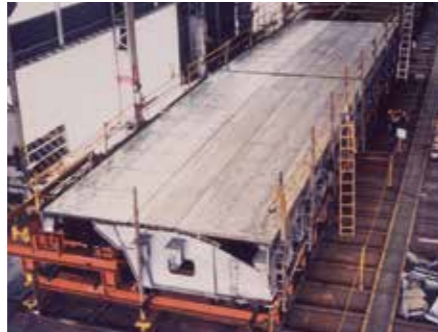
ローリングリーフ式伸縮装置 Rolling-Leaf Type Road Expansion Joint Device
