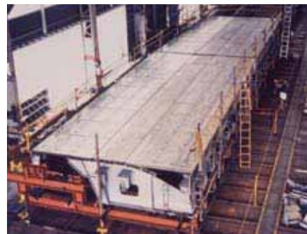
ローリングリーフ式伸縮装置 Rolling-Leaf Type Road Expansion Joint Device
