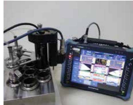
管端溶接部フェーズドアレイ超音波探傷検査システム Phased array UT system for tube to tubesheet weld joints
