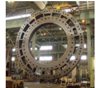
原子炉ペデスタル(基礎) Pedestal of nuclear reactor (basement)
