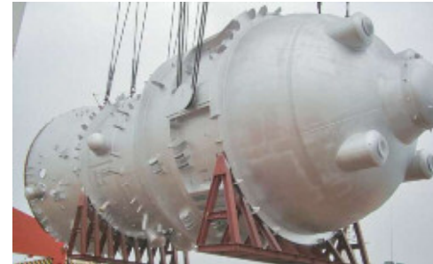
FCCリアクター FCC reactors
