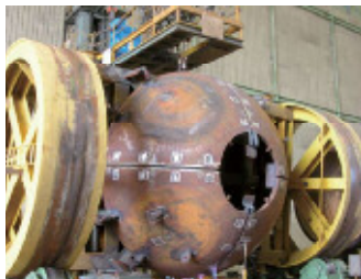
鏡板自動溶接（半球形） Automatic welding of the shell (Half spherical)
