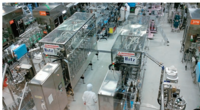
日立造船の充填機2台が活躍中。コンパクトながら、一台につき2,000本/1h(1.8ℓ容器基準)の充填が可能。品種切り替えや洗浄が容易で、効率的な多品種生産を可能としている
